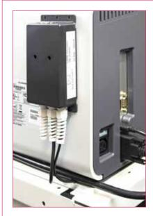
Für die nahtlose Verbindung zum Kuvertiersystem sorgt ein cleveres Zusatzgerät. Das stellt sicher, dass die kuvertierten Briefe vom Kuvertiersystem direkt in die Frankierstation transportiert werden.
