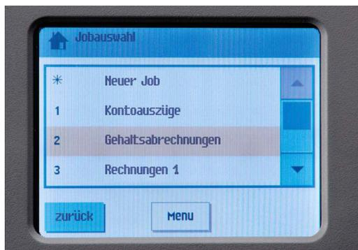
Auch das Erstellen neuer Jobs ist dank Load'n Go ein Kinderspiel. Nach dem Einlegen der Dokumente und Umschläge drücken Sie die Starttaste. Die DS-75 misst daraufhin automatisch die Länge der eingelegten Dokumente sowie Umschläge und nimmt die entsprechenden Einstellungen vor. Das Ergebnis kann sich sehen lassen: professionell verarbeitete Sendungen.
